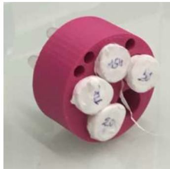
Figure 54: fantômes utilisés lors de la quantification in vitro de l'antenne dédiée au noyau sodium
