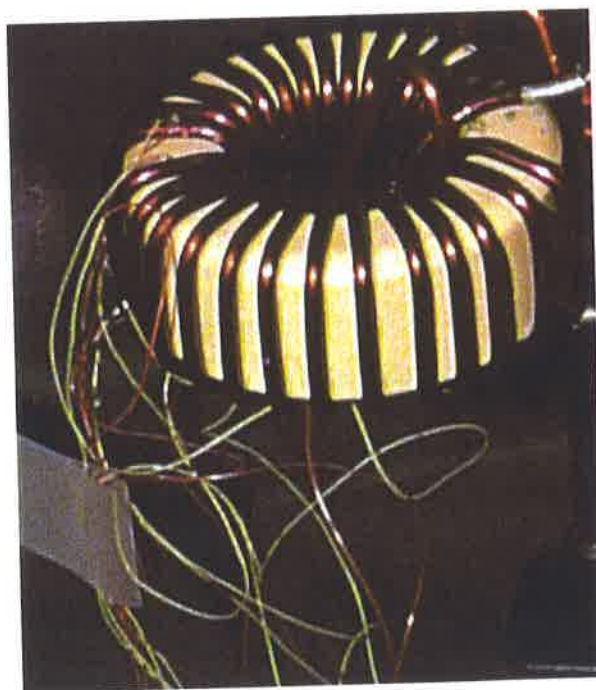
Figure 61 : Photographie de l'inductance équipée de thermocouples.
